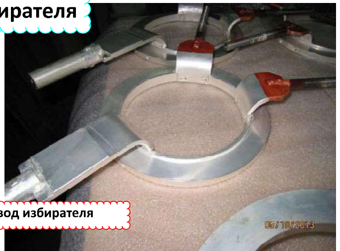
После механической обработки и наращивания меди
